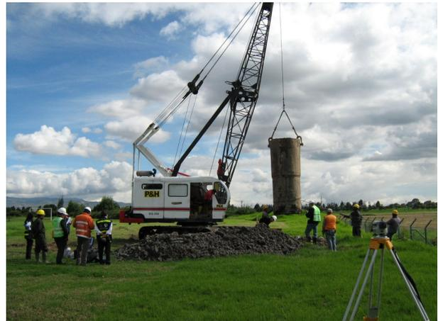
Foto No 1: Masa utilizada en las pruebas sobre los pilotes preexcavados. Masa de 14 ton. con altura de caída variable.
