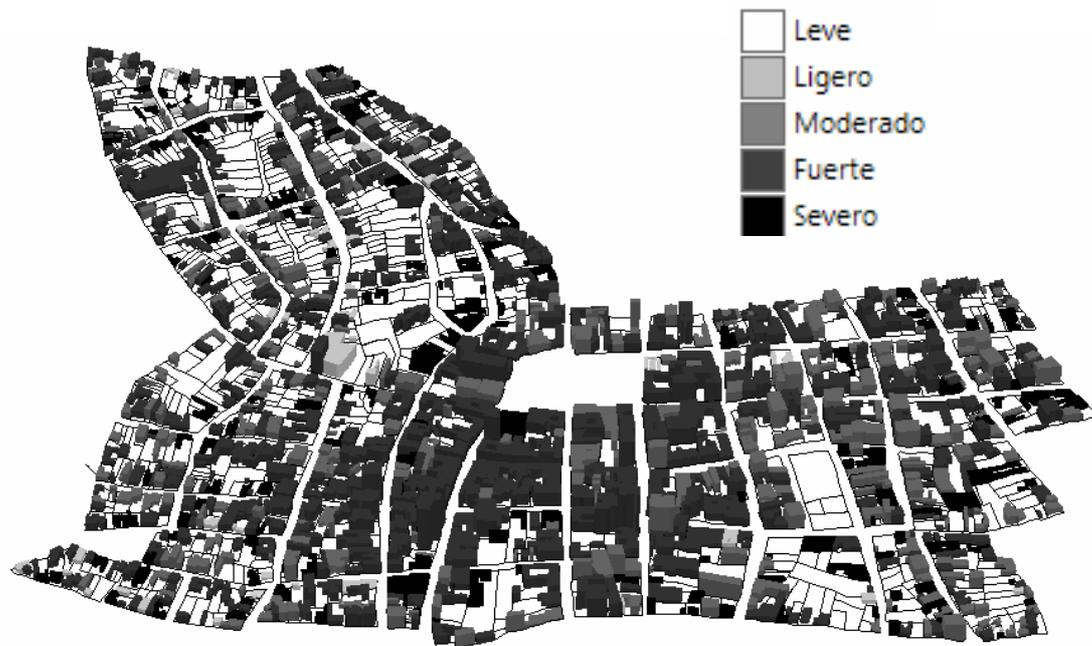
Figura 10. Escenarios de daño para  $A_a = 0.125$ . Sismo de Diseño
