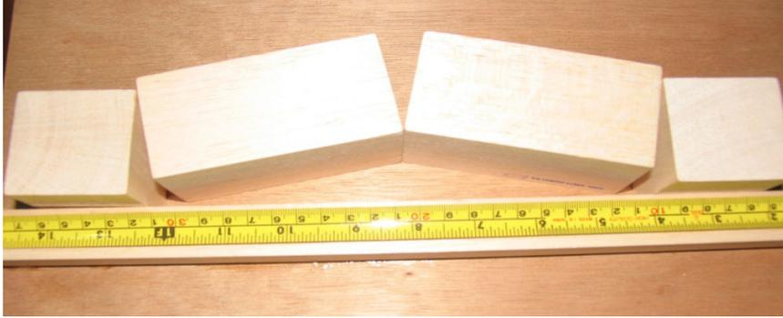
FIGURA No. 6b: CONDICIÓN DE LOS BLOQUES EN LA CONDICIÓN ARTICULADA
