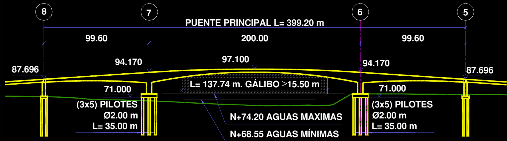
ALTERNATIVA 3. PUENTE EN CONCRETO
