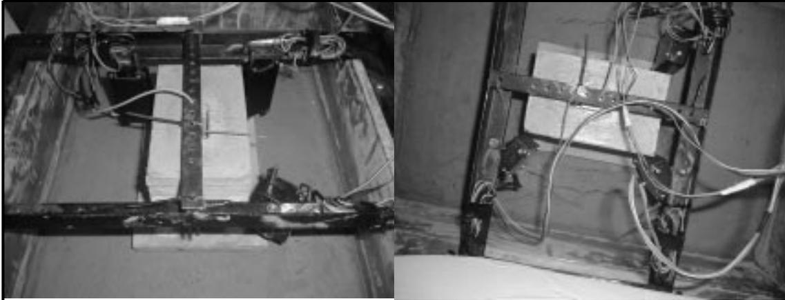
Figura 10. – Colocación de los Deformímetros
