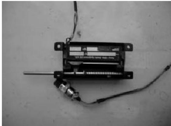
Figura 9.– Medidores de Desplazamiento
