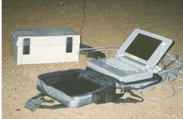
Figura 2.- Acelerómetro K2 y ordenador (Alfaro ,1997).
